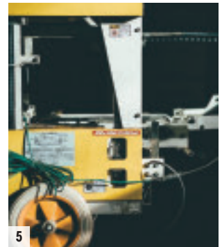
1. 邦男さんは18歳から就農して農業一筋 2. 左から、弟の修治さん、母の礼子さん、邦男さん、幸男さん、絵梨佳さん 3. ポットに種を入れ約2週間後に発芽。この日は、約2,200枚のポットを約6時間で作り上げた 4. 播種作業は一袋19kgもの培土を165袋も機械に入れる重労働 5. 播種後の苗箱を自動で積み上げるポット積上機
